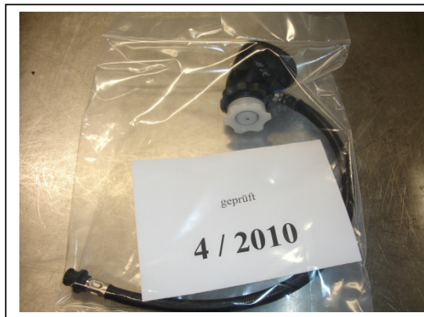
Abbildung 1: Durch eine Atemschutzwerkstatt gemäß BGI/GUV-I 8674 geprüfter und gekennzeichneteter Lungenautomat.
